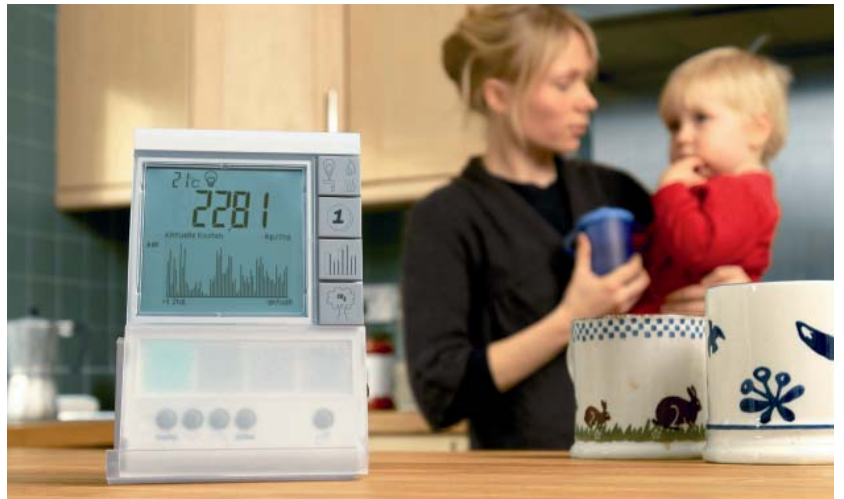
Genaue Kontrolle: Auf einem zentralen Steuerungsdisplay wird der aktuelle Energie- verbrauch angezeigt.
